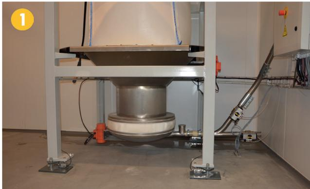
Le système de pesage silo a une double fonction. Dans un premier temps, il permet de contrôler les approvisionnements, les stocks et de gérer des niveaux d'alertes, niveau haut et niveau bas pour les réappro.
